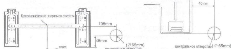
**ПРИМЕЧАНИЕ:** Пометьте положение отверстий и просверлите их в стене.
