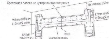
**ПРИМЕЧАНИЕ:** Крепления в отверстиях, указанных стрелкой, должны быть надежными, чтобы не было вибрации монтажной панели. Когда используются распорные болты, необходимо просверлить два отверстия (11X20 или 11X26), и расстояние между ними должно быть 450 mm.
