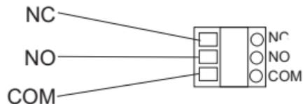
Зажимы для подключения проводов находятся на тыльной стороне приемника RX под крышкой и обозначены соответственно: NC, NO и COM. Это выводы контактной группы на переключение двухполюсного исполнительного реле (с двумя устойчивыми состояниями). Обычно вывод NC не используется.
