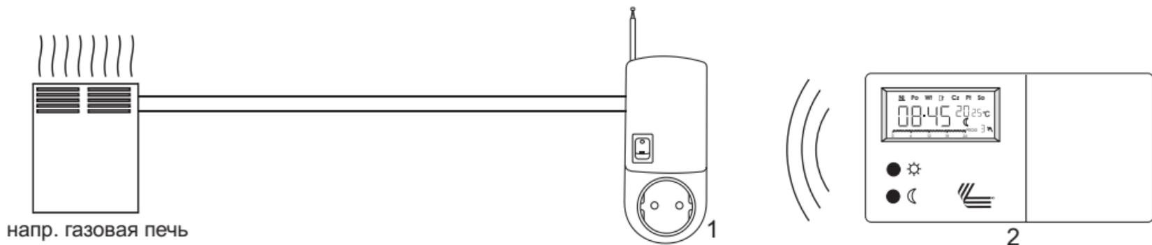
1. Приемник **AURATON 2005 RX Plus** (устанавливается непосредственно около управляемого оборудования).
